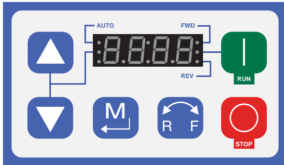
Figure 15 VFD 제어 패널
