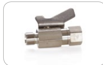
Artikelnummer Einlass/Auslass NPT 237535 3/8" NPT(i) x 3/8" NPSM(a)
