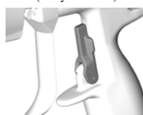
Spust odblokowany (natryskiwanie)
