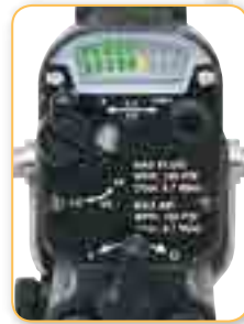
Smart Display 便于实时读取静电喷枪的工作电压和电流
