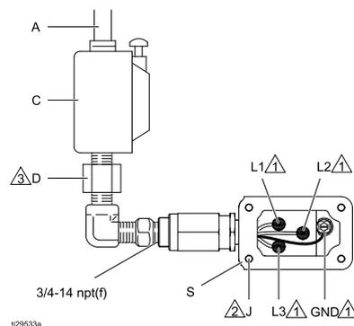
Figure 4 Ligue os fios de alimentação, trifásico
