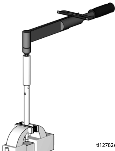
Рис. 2. Удаление проточной гайки
