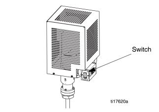
Fig. 12: Agitator Switch
