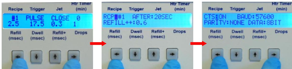
Figure 4-2 : appuyez sur gauche+droite deux fois pour les paramètres par défaut du RS-232
