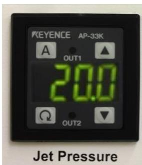
Figure 3-3 : manomètre de projection
