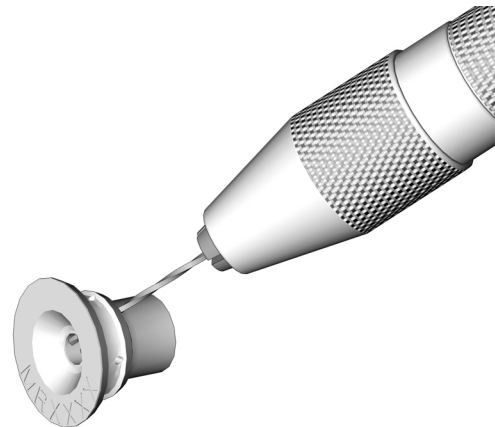
ABB. 2. Säuberung der Schlitze für Komponente B (Kunstharz)
