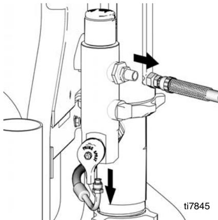
3. Utilizando uma chave, desaperte o acessório da caixa do filtro (110) até à caixa e retire-a da bomba.
