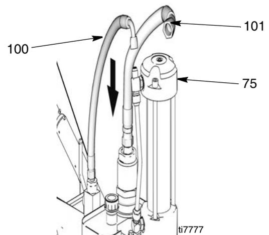
4. Para retirar o ar dos tubos hidráulicos, aumente a pressão o suficiente para activar o motor hidráulico e deixe o líquido circular no motor durante 15 segundos; baixe a pressão e rode a válvula de segurança para a posição horizontal (fechada).
