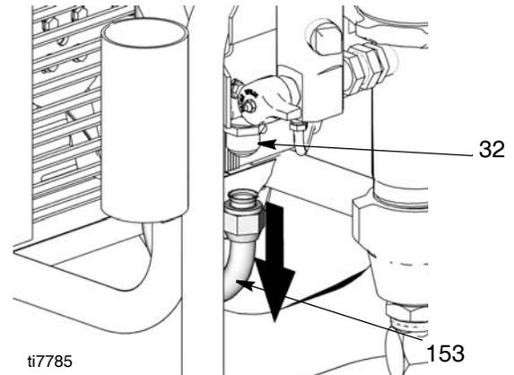
5. Retire e mantenha o acessório de aspiração (32) para o utilizar no novo depósito.
