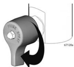
*Se suspeitar que o bico ou o tubo flexível estão completamente entupidos ou que a pressão não foi completamente aliviada depois de ter seguido os passos acima indicados, MUITO LENTAMENTE, vá desapertando a porca de retenção do protector do bico ou a união da extremidade do tubo flexível para efectuar uma descompressão gradual, e, de seguida, desaperte completamente. Por fim, limpe o bico e o tubo flexível.*
