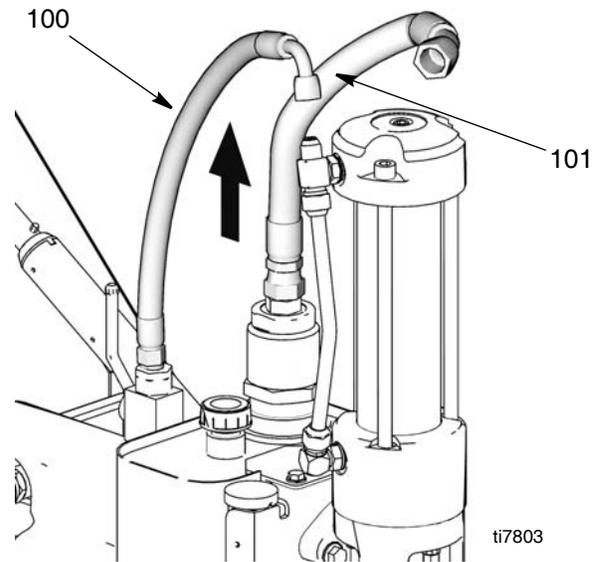
7. Retire o tubo do arrefecedor do depósito (64).
