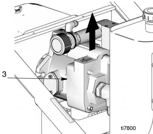
12. Retire os acessórios (30, 34, 35) da bomba (3) e coloque-os de parte para os utilizar na nova bomba.
