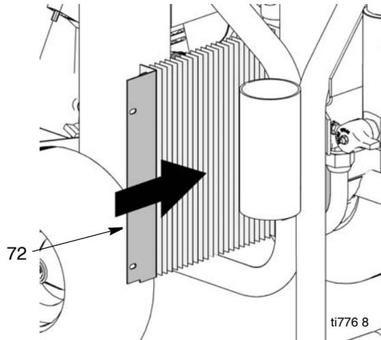
2. Volte a ligar o tubo de retorno ao depósito de óleo e o tubo hidráulico ao arrefecedor. Aperte a um binário de 225 pol.-lbs (25,4 N•m).
