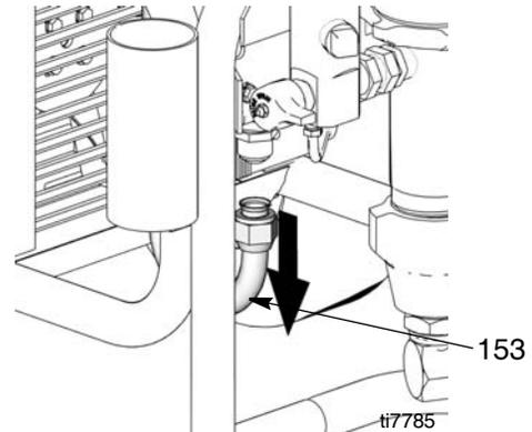
7. Verifique se o bujão de drenagem está colocado. Encha o depósito de óleo até à marca superior da respectiva vareta (cerca de 3,5 galões).
