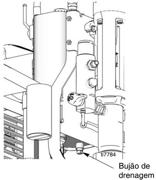
5. Volte a colocar os tubos de retorno (100, 101). Aperte a um binário de  $450 \pm 10$  pol.-lbs ( $51 \pm 1,1$  N•m).
