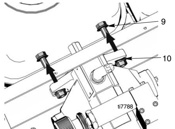
11. Retire a bomba hidráulica (3).
