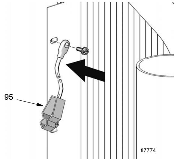
4. Volte a colocar a barra e os parafusos. Aperte a um binário de 25-30 pol.-lbs (2,8-3,4 N•m).
