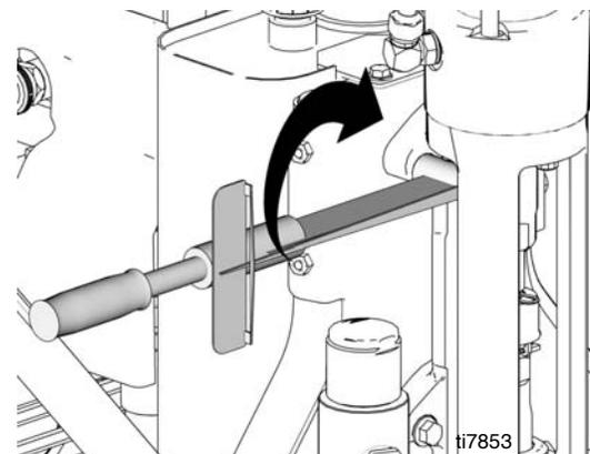
3. Volte a instalar os tubos flexíveis (100, 101) na cabeça (75). Aperte a um binário de  $450 \pm 10$  pol.-lbs ( $50,84$  N•m).
