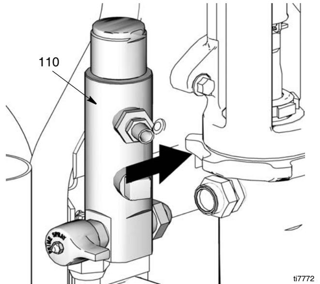
9. Ligue o tubo flexível de aspiração (147) à saída da bomba (36).
