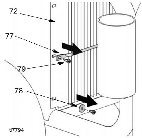
5. Retire a bobina (72) da estrutura do equipamento.
