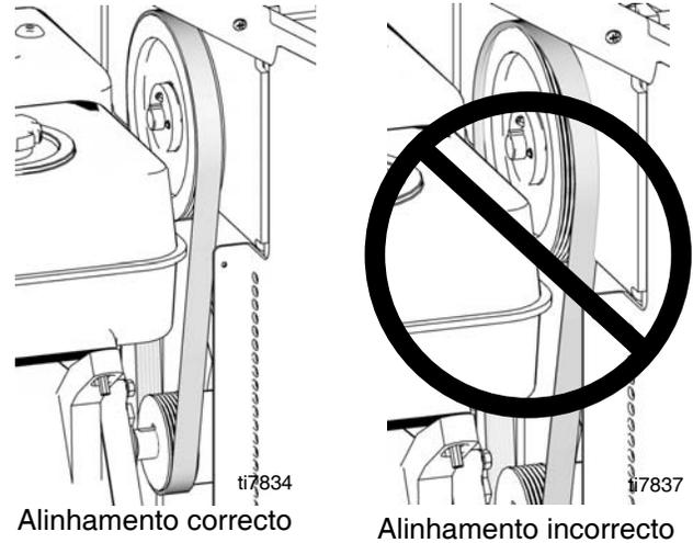
**NOTA:** se a correia não estiver correctamente alinhada, para a ajustar, puxe lentamente o ressalto do motor enquanto puxa ou empurra a correia para a reposicionar sobre a polia.
