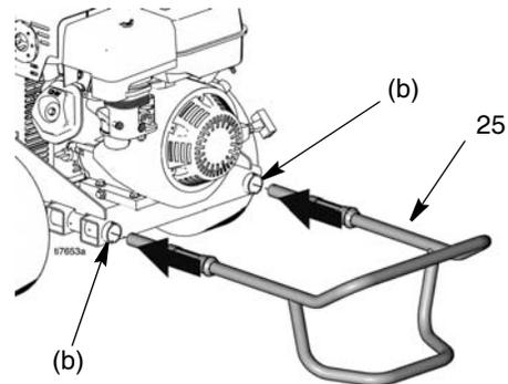
6. Instale os parafusos de manga (143) nos tubos inferiores da estrutura.
