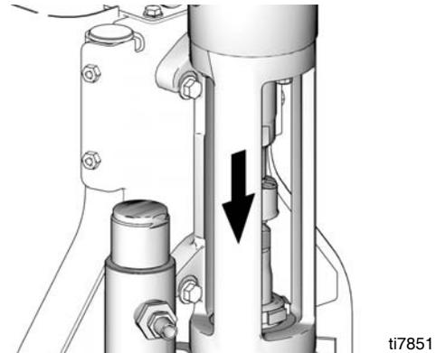
2. Aperte os parafusos da cabeça de bomba (7). Aperte os parafusos a  $400 \pm 10$  pol.-lbs ( $45 \pm 1$  N•m).
