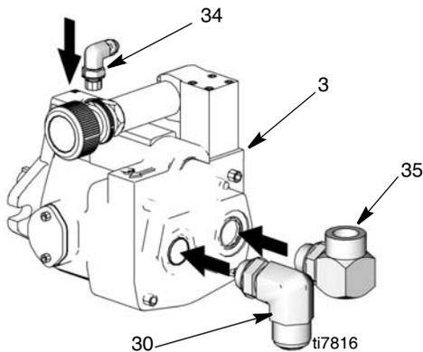
Nota: Preencha carcaça da bomba com óleo hidráulico antes de instalar o encaixe (34).
