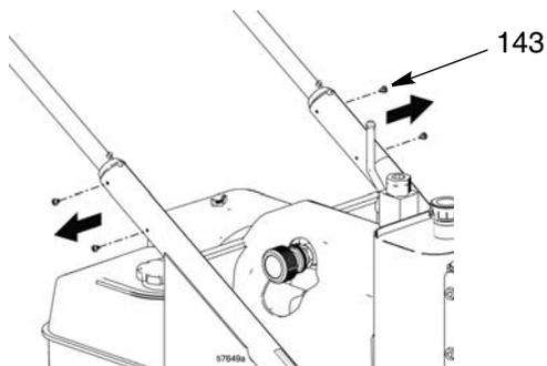
2. Retirar o conjunto do cabo (25) puxando-o para fora dos tubos superiores da estrutura (1).
