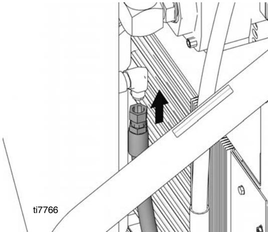
6. Volte a colocar o tubo de aspiração (153). Aperte a um binário de  $600 \pm 10$  pol.-lbs ( $68 \pm 1,1$  N•m).
