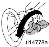
**Ponta da Pulverização Direcionada para a Frente (Posição de PULVERIZAÇÃO)**
