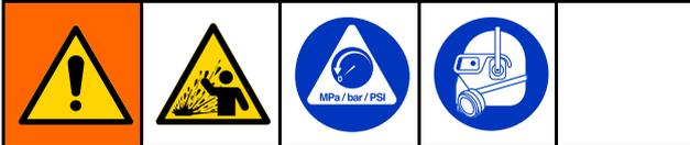
Das Gerät bleibt druckbeaufschlagt, bis der Druck manuell entlastet wird. Um die Gefahr schwerer Verletzungen aufgrund von unter Druck stehendem Material, wie z. B. Spritzern in die Augen oder auf die Haut, zu vermeiden, der Vorgehensweise zur Druckentlastung nach dem Stopp der Pumpe und vor dem Reinigen, Überprüfen oder Warten des Geräts folgen.
