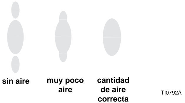
FIG. 6. Problemas del patrón de pulverización
