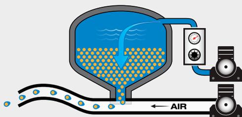
*Le Vapor Blasting offre un contrôle maximal de la pression de l'air et du mélange eau/abrasif, ce qui permet de sabler une plus grande surface tout en réduisant le besoin en média.*
