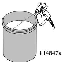
5. Tournez la vanne d'amorçage vers le bas en position et d'autoriser liquide de rinçage à circuler jusqu'à ce fluide de rinçage apparaisse clairement.
