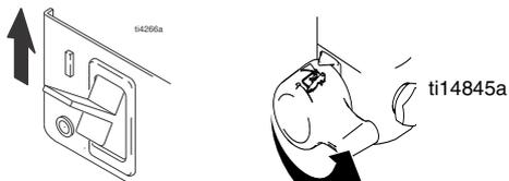
3. Augmentez la pression à 1/2. Maintenez le pistolet contre un seau de peinture. **DEVERROUILLER** la gâchette. Actionnez le pistolet jusqu'à ce que le fluide de rinçage apparaisse.
