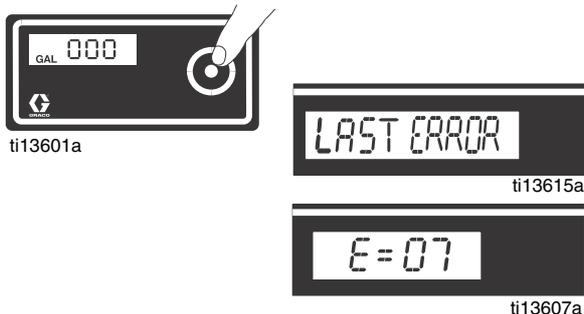
6. Appuyez sur le bouton DTS et le maintenir enfoncé pour effacer le code d'erreurs et le ramener à zéro.
