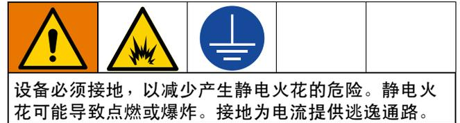
**泵：**使用接地导线和线夹（已提供）。将接地导线 (L) 连接至气动马达的接地栓上。将接地夹子连接到真正的地面。
