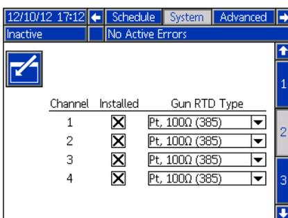
Это меню предназначено для включения установленных каналов и указания типа используемого в системе резистивного датчика температуры для пистолета. См. раздел **Настройка ADM** на стр. 21.
