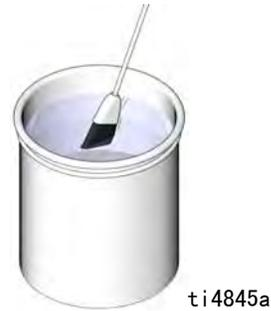
图 15: 使用经溶剂浸泡的软毛刷
