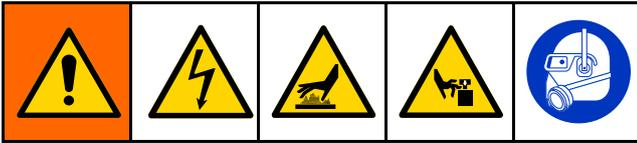
Para prevenir lesiones graves, utilice únicamente Reactor con todas las cubiertas y carenados colocados en su lugar.
