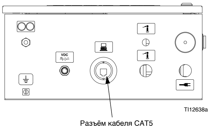
Рис. 34: EasyKey и точки подключения кабеля к модулю
