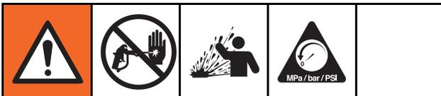
怪我の危険性を減少させるために、システムのいかなる部品を点検または整備する前、および圧力を開放するよう指示された場合、必ず **圧力開放手順**, page 27 に従ってください。
