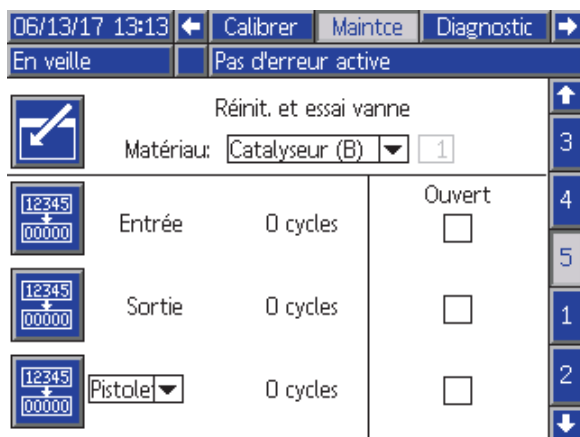
Figure 83 Écran de maintenance 5, catalyseur commun
