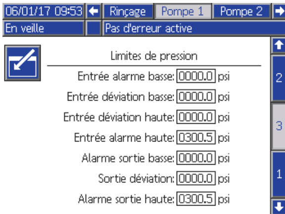
Figure 52 Écran de pompe 3, surveillance de pression activée
