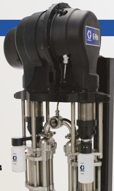
Эффективность поршневого насоса + эффективность энергопотребления за счет использования электропривода E-Flo™. Наличие двух гидроцилиндров позволяет минимизировать перепады давления на выходе насоса. Модульность конструкции сокращает время простоев. Возможность удаленного мониторинга с помощью компьютера или ПЛК позволяет улучшить контроль работы оборудования.
