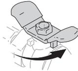
3. Coloque el cabezal de aire aflojando el anillo de retención del cabezal de aire y gire éste para obtener un chorro de pulverización vertical u horizontal. Apriete el anillo de retención hasta que el cabezal de aire esté firmemente sujeto; no debe ser posible girar a mano el cabezal de aire.
