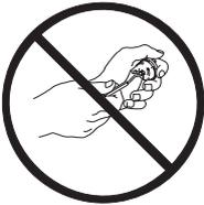
No utilice herramientas de metal para limpiar los orificios del cabezal de aire y de la boquilla de pulverización ya que pueden rayarse. Compruebe que el electrodo no está dañado. Las rayaduras en los orificios del cabezal de aire o la boquilla y ó un electrodo en mal estado pueden distorsionar la forma del patrón de pulverización.
