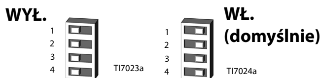
Rys. 7. Ustawienia przełącznika typu DIP (SW2)
