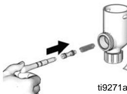
2. Insérez le guide du ressort avec le joint torique dans l'écrou de réglage du débit. Assurez-vous que l'extrémité qui dépasse du guide est orientée tel qu'indiqué.
