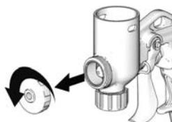
7. Tenez fermement le pointeau en place afin d'éviter des rotations lorsque vous tournez la commande de débit dans le sens des aiguilles d'une montre jusqu'à ce que le pointeau soit désenclenché du filet et libéré. Retirez le pointeau et les joints toriques par l'avant du pistolet.
