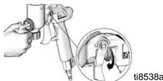
6. Lorsque vous insérez le pointeau dans le pistolet, tournez l'écrou de réglage du débit dans le sens inverse des aiguilles d'une montre pour serrer le pointeau.
