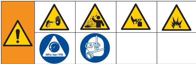
Dieses Gerät bleibt unter Druck, bis der Druck manuell entlastet wird. Zur Vermeidung schwerer Verletzungen durch Material unter Druck – z. B. Penetration von Material in die Haut, Materialspritzer oder bewegliche Teile – immer die Druckentlastung durchführen, wenn mit dem Spritzen aufgehört wird und bevor die Anlage gereinigt, kontrolliert oder gewartet wird.
