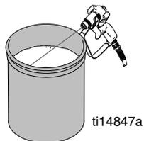
5. 将填料阀旋转至泄流位置以循环冲洗流体，直到出现洁净的冲洗流体。
