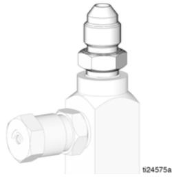
**Adaptador de tubo de conexión a presión:**
