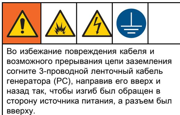
8. Подсоедините 3-проводной ленточный соединитель (PC) к источнику питания. Спрячьте ленту под источник питания. Опустите генератор переменного тока (15) вниз и установите его на источник питания (11).
