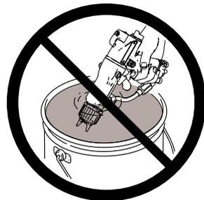
8. Очистите воздушную крышку/защитную насадку и распылительный наконечник мягкой щеткой и невоспламеняющимся растворителем.
