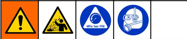
Cet équipement reste sous pression tant que la pression n'a pas été relâchée manuellement. Pour éviter de sérieuses blessures provoquées par du produit sous pression, comme des éclaboussures dans les yeux ou sur la peau, exécuter la procédure de décompression lorsque le pompage est arrêté et avant un nettoyage, une vérification ou un entretien de l'équipement.
