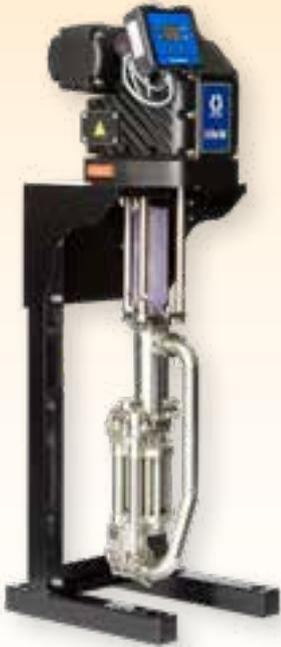
与连接在一起并实现同步控制的同类泵不同，固瑞克泵的两个下缸体可独立运行。这就使泵能够以每秒钟数千次的频率调整压力和流量的变化需求。需要维护时，每台泵还可以单独运行以保持生产运行的连续性。
