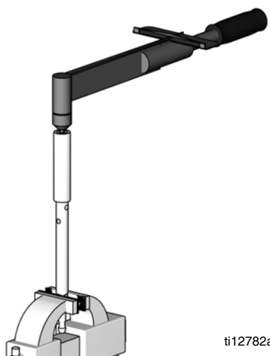
FIG. 2. Rimuovere il dado di flusso passante
