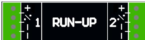
1. ライン速度に基づいてポンプ圧力を変更する為には、二つまでの “I/P” あるいは “V/P” ランアップエア圧力レギュレーターを接続して下さい。ハードウェアは自動的に I2P あるいは V2P が接続されているかを検知します。
