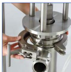
Toutes les pompes à piston SaniForce sont équipées de bas de pompe à démontage rapide pour un nettoyage rapide et facile !
