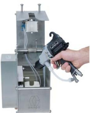
Автоматическая промывка с использованием оптимального количества растворителя, сокращение расхода материала
