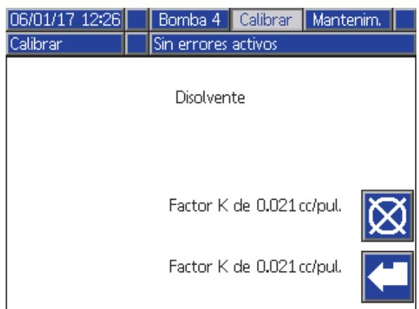
Figure 59 Aceptar calibración
