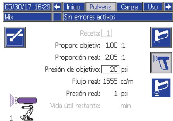
Figure 22 Pantalla de pulverización, en modo de mezcla
