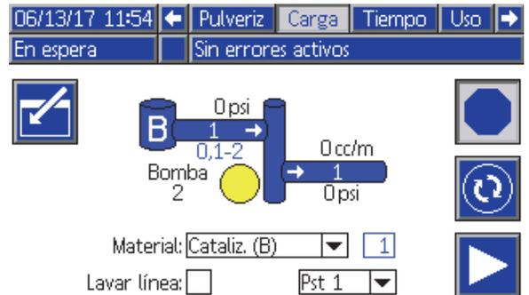
Figure 80 Pantalla de llenado, catalizador común
