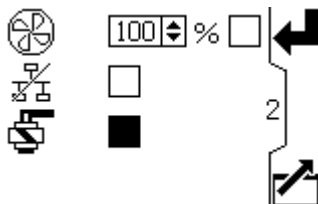
Figure 12 Controllo del solenoide della pompa di riempimento manuale
