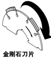
270 和 390 型号是针对“前切”碾磨（轮的旋转方向与其前进方向一致）而设计的。480 和 630 型号是针对“反向（上切）”碾磨（轮的旋转方向与其前进方向相反）而设计的。
