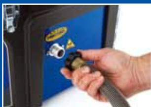
喷涂机和喷枪上的空气和涂料软管连接无须使用任何工具
