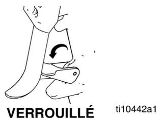
5. Ouvrez les vannes d'entrée de fluide ainsi que les clapets à bille situés dans les réservoirs de produit. Si cela s'applique, les clapets à bille des réservoirs de produit comprennent une alimentation en produit, un retour d'applicateur et une décompression. Recherchez d'éventuelles fuites.
