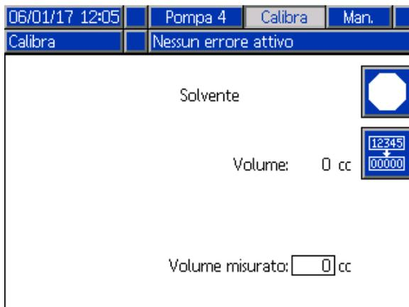
Figure 58 Immettere il volume misurato di solvente
