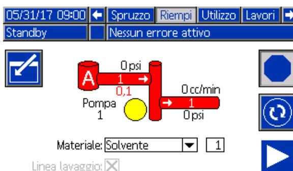
Figure 25 Schermata di riempimento, solvente selezionato
