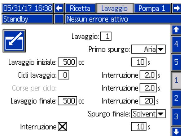
Figure 44 Schermata Lavaggio con Interruzione aria/solvente
