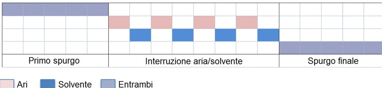
Figure 45 Diagramma dei tempi di interruzione aria/solvente
