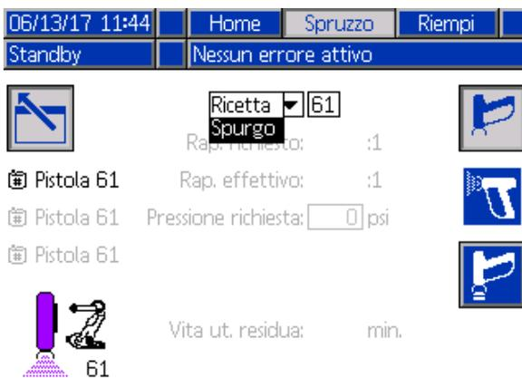
Figure 79 Spurgo nella schermata di spruzzatura
