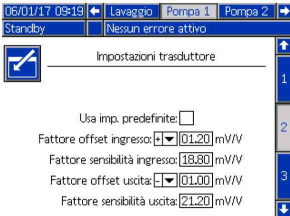
Figure 50 Schermata della pompa 2, Impostazioni predefinite disattivate
