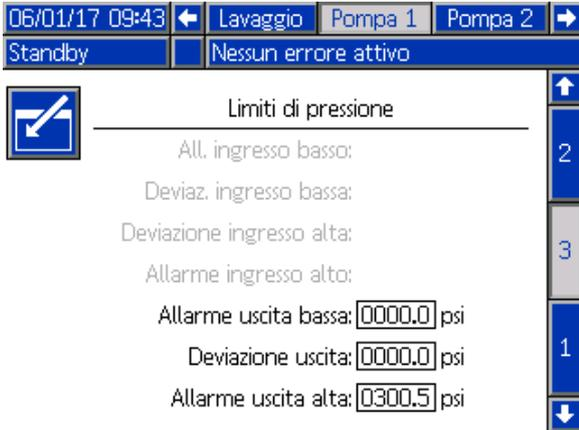
Figure 51 Schermata della pompa 3, Monitoraggio pressione disattivato
