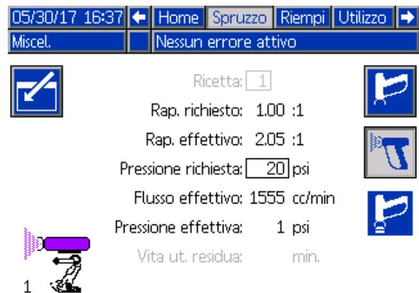
Figure 22 Schermata di spruzzatura, in modalità miscelazione
