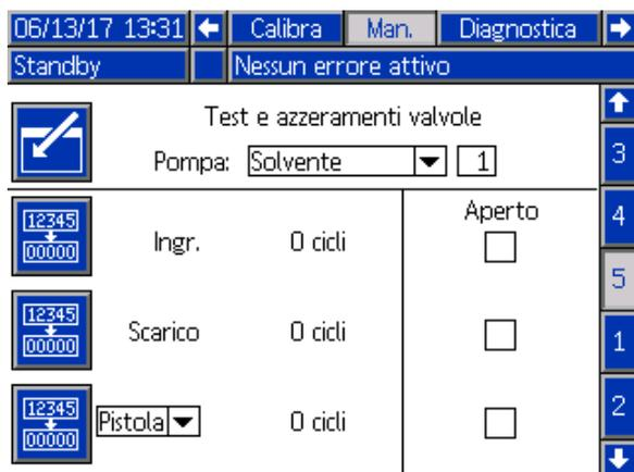
Figure 84 Schermata di manutenzione 5, solvente
