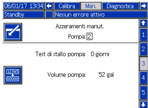
Figure 62 Schermata di manutenzione 3, stato attuale della pompa
