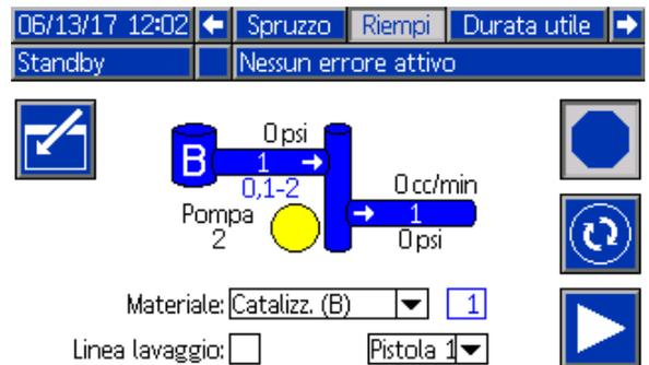
Figure 80 Schermata di riempimento, catalizzatore comune
