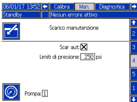
Figure 63 Schermata di manutenzione 4, scarico manuale della pompa
