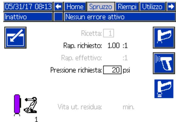
Figure 23 Schermata di spruzzatura, in modalità neutra
