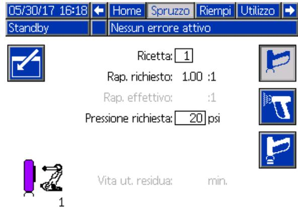
Figure 21 Schermata di spruzzatura, in modalità standby
