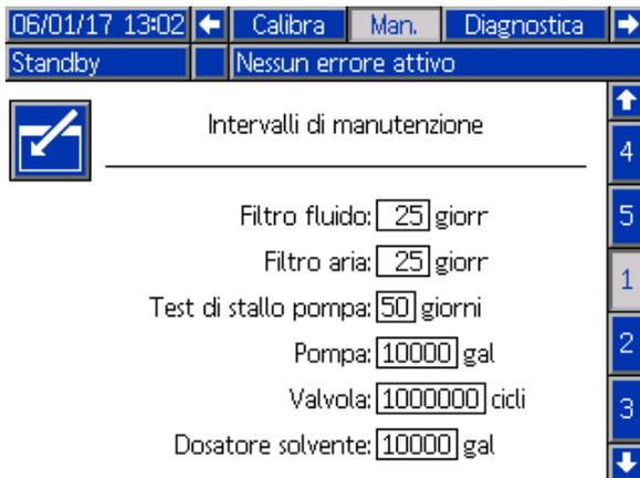
Figure 60 Schermata di manutenzione 1, impostazione degli intervalli
