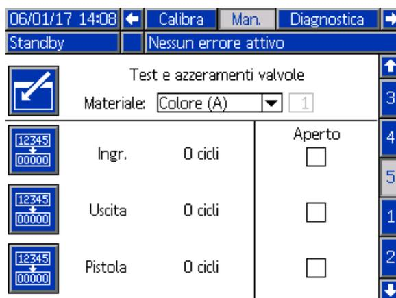
Figure 64 Schermata di manutenzione 5, reset valvola del colore
