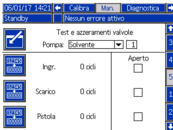
Figure 65 Schermata di manutenzione 5, reset valvola del solvente
