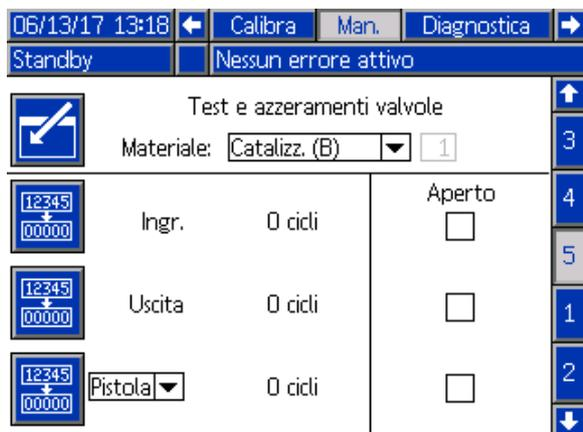
Figure 83 Schermata di manutenzione 5, catalizzatore comune
