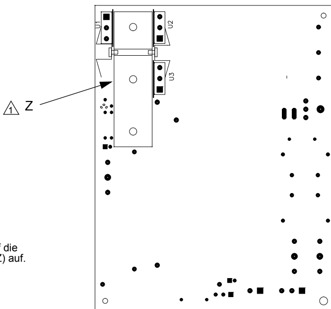
Rückseite der Barriere-Platine mit Kühlkörper (Z)
