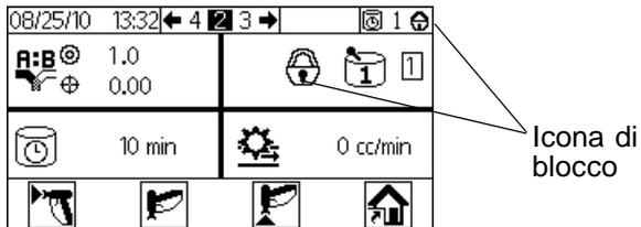
**FIG. 23. Modalità di blocco del sistema**
