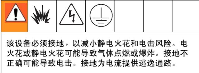
1. 通过与流量计外罩或传感器相连接的接地线缆，对流量计进行接地。
