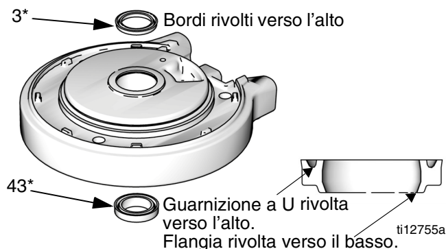
FIG. 12: Installazione della guarnizione a U del motore pneumatico
